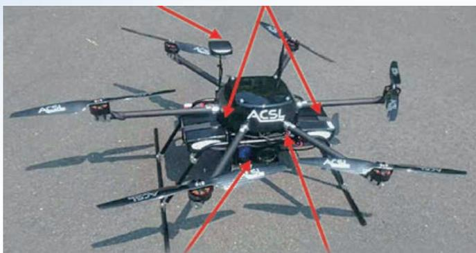
カメラジンバル機構      映像伝送装置
