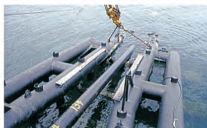
パイプ水中支持装置 (スティンガー)
