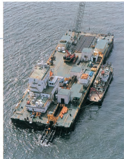
海底パイプ 敷設船
