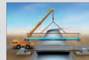
クレーンで吊り上げ一括架設します。
